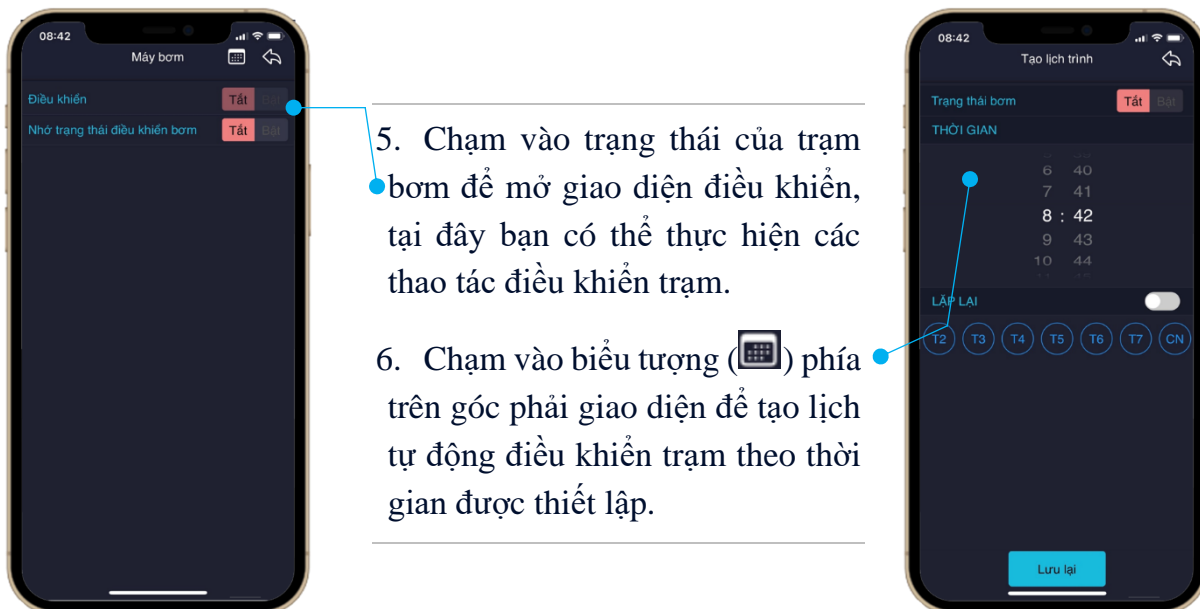
Hình 39. Điều khiển và đặt lịch tự động điều khiển trạm bơm
